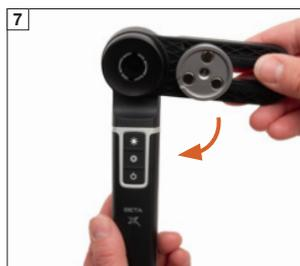
Anstelle des Magnifier Moduls setzen Sie den Smartphone Adapter plan auf und drehen Sie ihn im Uhrzeigersinn fest. Überprüfen Sie, ob der Adapter mit der gesamten Fläche aufliegt und vollständig eingerastet ist.
