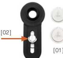
Sollten beide dennoch aneinander haften, trennen Sie die Schraube [02] vom Adapter-Arm. Drehen Sie die Schraube direkt in das Gewinde des Magnethalters und schieben Sie die beiden Elemente auseinander.
